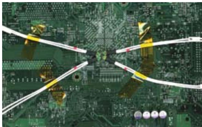
Рис. 38. Электронные схемы с высокой плотностью монтажа требуют применения малогабаритных пробников.
