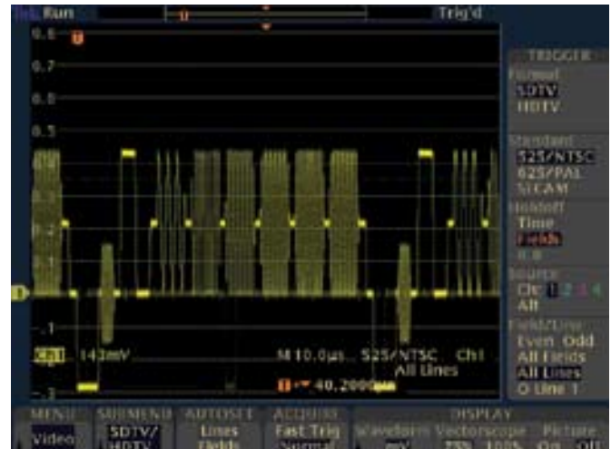
Рис. 57. Программные модули для видеоизмерений превращают осциллограф в быстрый и универсальный прибор для диагностики видеооборудования.
