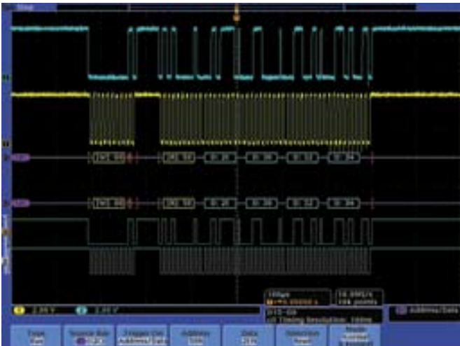
Рис. 54. Анализ сигналов последовательных шин ускоряется за счет автоматического запуска, декодирования и поиска по содержимому пакета последовательных данных.
