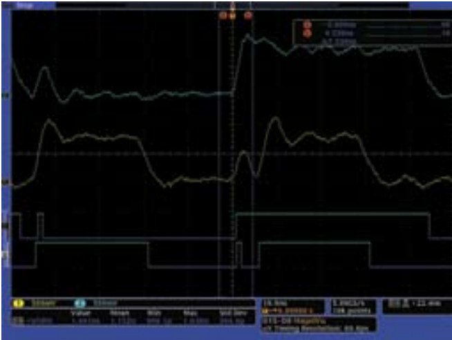
Рис. 51. MSO имеет 16 встроенных цифровых каналов, позволяющих отображать и анализировать коррелированные по времени аналоговые и цифровые сигналы. Высокая скорость регистрации по времени обеспечивает большое разрешение, позволяющее обнаруживать кратковременные события, например, глитчи.
